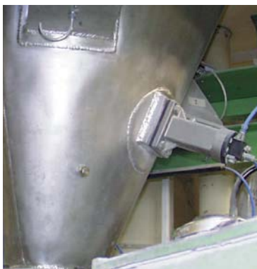
Décolmatage de parois de silos
