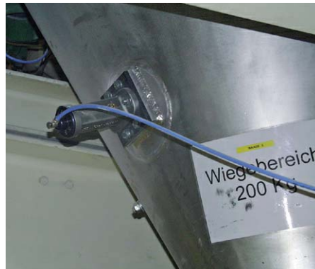
Décolmatage de réservoirs de pesage
